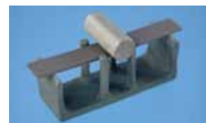
次に5gのプレシャスメタルで荷重をかけて焼成する。焼成温度は900℃と930℃の2回。
