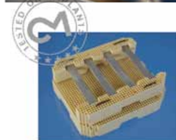
合金1種類あたりの標本は4つ。初めに荷重なしの状態での960℃で焼成する。
