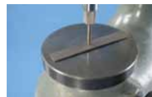
焼成後にそれぞれの合金の変形量を測定する。
