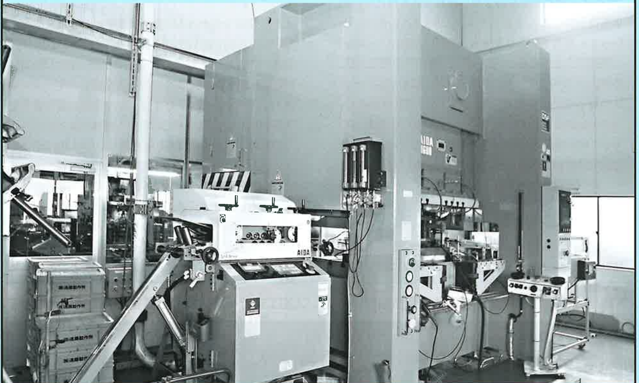
▲ダイレクトサーボフォーマー DSF-N2-1600 (160トン) + レベラーフィーダー LFA-L
