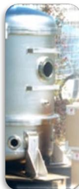
大型製品（最長4500mm）までの金属製品に対して、一度にNi-Pを行えるラインを完備しています。この技術は国内でも類を見ない技術となります。また、従前（塗装処理等）で防錆を行っていた製品に対しても応用可能で、市場参入も見込まれると予想しています。
