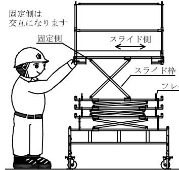
② 折り畳んだ左右のタラップを起こし、上部フレームの横桿に合わせ、先端のタラップ止め金具(左右2ヶ所)を締め付けます。
