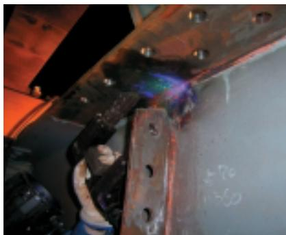
疲労亀裂調査 (磁粉探傷)
