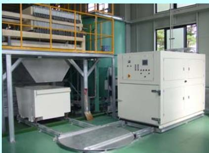
ターンテーブルによりスラッジバケットの方向転換が容易になり、切り返しのスペースを最小限に押さえる
