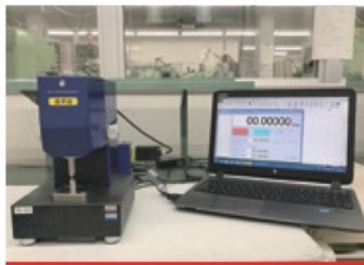
接触式外径測定器 DS-2000 (ユニオンツール)
