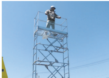
昇降式移動足場
