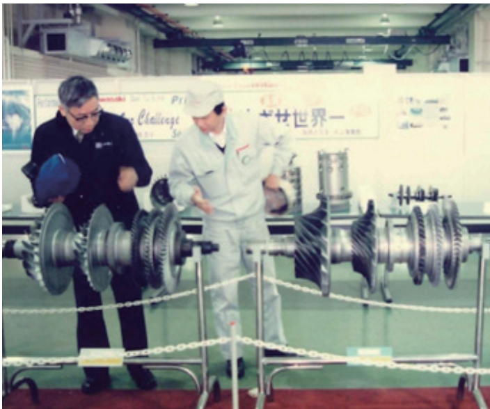
ノーウォーク病院 トラブル原因調査。 ガスタービン2000kw発電機の損傷原因 を製造メーカーの現場で実地検査、基礎 資料より判定。 (明石市)
