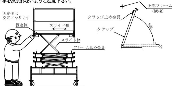
② 折り畳んだ左右のタラップを起し、上部フレームの横棧に合わせ、先端のタラップ止め金具(左右2ヶ所)を締め付けます。
