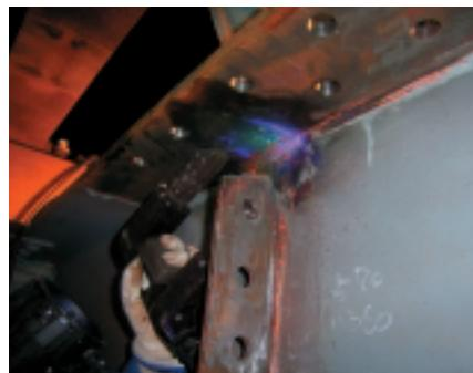
疲労亀裂調査(磁粉探傷)
