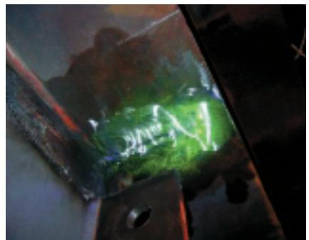
疲労亀裂調査(磁粉探傷)
