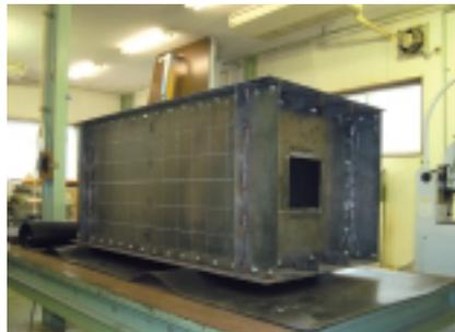
鋼箱桁模型(外観)
