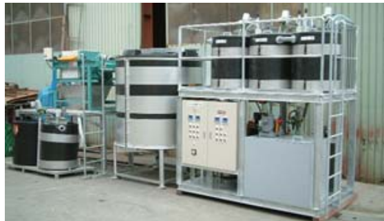
塗装前処理ユニット式排水処理設備(処理能力: 1m 3 /hr)
