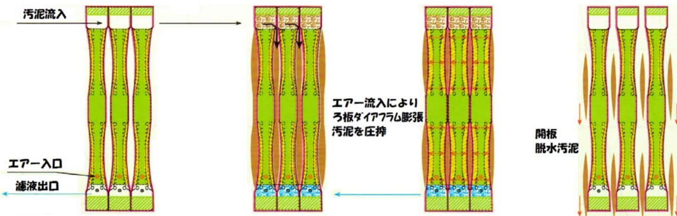
ろ板がダイアフラム式になっていて、汚泥(スラリー)流入後、エア注入によりダイアフラムが広がり、汚泥を圧搾します。
